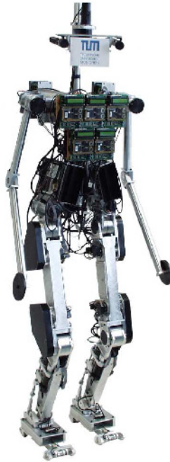
Abb. 1.4. Roboter „Johnnie“ (mit freundlicher Genehmigung von H. Ulbrich, F. Pfeiffer, Lehrstuhl für Angewandte Mechanik, TU München), ©TU München
