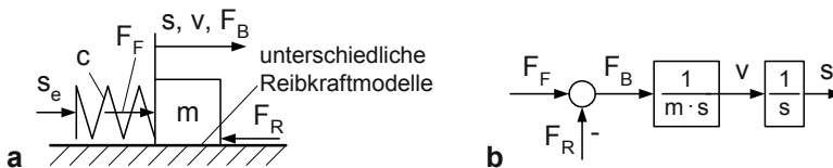
Abb. 4.6 Feder-Masse-System mit unterschiedlichen Reibkraftmodellen. a Schema b Blockschaltbild des 2. und 3. Schrittes
