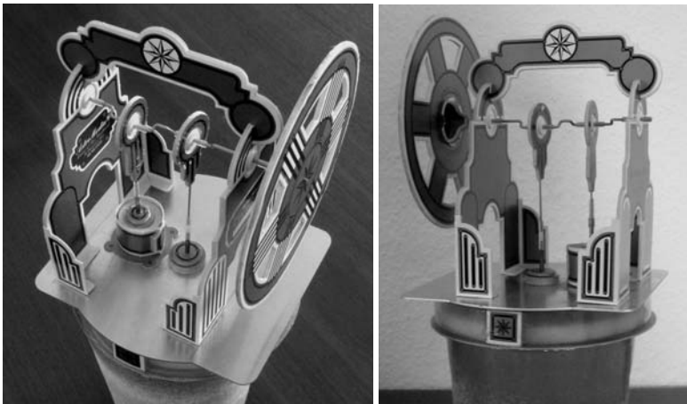
Abb. 6.15 Aus einem Bausatz hergestellter Stirlingmotor mit Verdränger in zwei Ansichten
