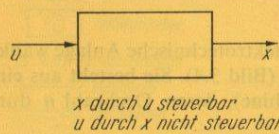
Bild 3.5. Symbol eines allgemeinen rückwirkungsfreien Übertragungsglieds bei Darstellung in Wirkungsschemata (in Blockschaltbildern)
