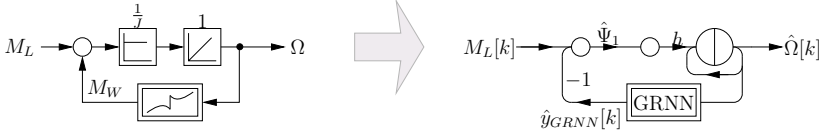
Abb. 6.2: Transformation der Mechanik einer elektrischen Maschine in ein rekurrentes Netz
